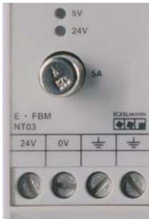
Die Modulelektronik wird durch eine Stecksicherung Microfuse 5A, 125V (Hersteller Wickmann Nr. 303-1500-042) geschützt.
