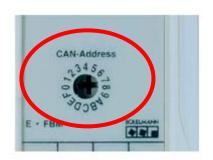
Die Einstellung der Knotenadresse erfolgt über einen frontseitig zugänglichen Hex-Schalter (4 niederwertige Adressenbits) und über fest verdrahtete Brücken innerhalb des Gehäuses (3 höherwertige Adressenbits). Innerhalb eines Modultyps sind somit maximal 16 Module möglich.
