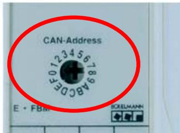
Die Einstellung der Knotenadresse erfolgt über einen frontseitig zugänglichen Hex-Schalter (4 niederwertige Adressenbits) und über einen Codierschalter innerhalb des Gehäuses (3 höherwertige Adressenbits). Innerhalb eines Modultyps sind somit durch Codierung über den Hex-Schalter maximal 16 Module möglich.
