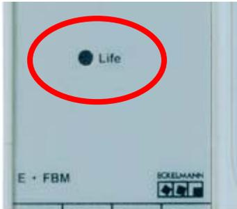
Versorgungsspannung an: Sobald die Versorgungsspannung eingeschaltet wurde, befindet sich das Modul im Zustand der automatischen Baudratenerkennung. Die Life-LED im Kopf des Moduls blinkt mit 8 Hz. Nach Erkennung der Baudrate erfolgt die interne Initialisierung des Moduls. Danach befindet sich das Modul in dem internen Status *Preoperational*. Das Modul befindet sich nun in Bereitschaft und erwartet Ansteuerbefehle über den CAN-Bus. Die Life-LED blinkt mit 0,25 Hz.
