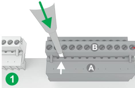
1 Insérer le tournevis (4 mm) à gauche entre la douille (A) et la contre-fiche (B).
