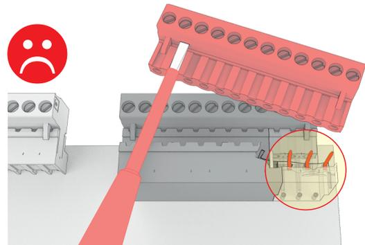
Lorsqu'elles sont tordues, les tiges de la douille peuvent entraîner un défaut et une panne de la commande !
