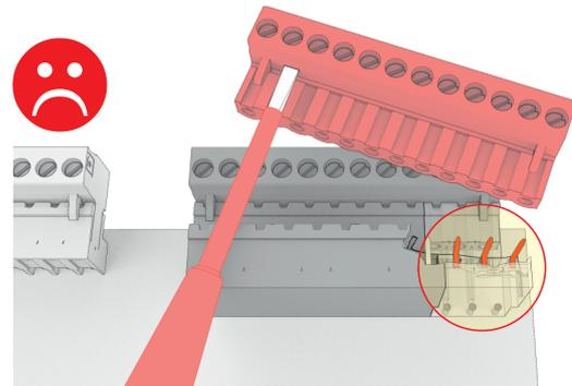
Verbogene Stifte der Steckerbuchse führen zum **Defekt und Ausfall der Steuerung!**
