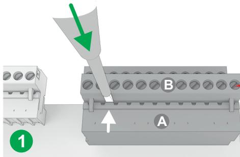
Schraubendreher (4 mm) links zwischen Steckerbuchse (A) und Gegenstecker (B) stecken.
