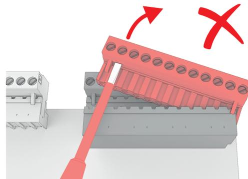
Gegenstecker **niemals** einseitig lösen, da dadurch Stifte der Steckerbuchse beschädigt werden!
