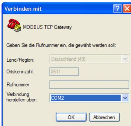
Es muss der Anschluss ausgewählt werden, an dem das Null-Modem-Kabel aufgesteckt ist (z.B. COM2).
