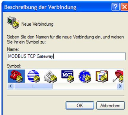
Nach dem Start des Programms muss zuerst ein Name (z.B. Modbus-TCP-Gateway) und ein Symbol für die gewünschte Verbindung angegeben werden.
