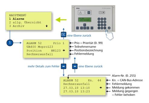
Praxis-Tipp: Ein Wechsel zwischen der Detail-Anzeige erfolgt durch Drücken der Tasten ← und →.
