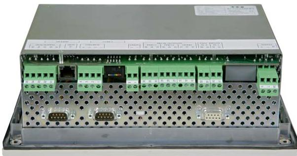
Das Bedienterminal AL 300 S für die Schalttafelmontage ist in einem Metallkäfig mit Kunststofffront (1) untergebracht und kann entweder in einem Schaltschrank (AL 300 S) oder einem Kunststoffgehäuse (AL 300 W, siehe Kapitel 4.2) montiert werden. Die Leitungsaufnahme des Bedienterminals AL 300 S beträgt 5 VA. Bei der Montage ist darauf zu achten das genügend Abstand zum darüber bzw. darunter liegenden Gerät oder Kabelkanal zur Wärmeabfuhr zur Verfügung steht.
