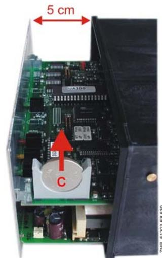
5. Batterie (c) nach oben aus der Batteriehalterung herausziehen und fachgerecht entsorgen.
