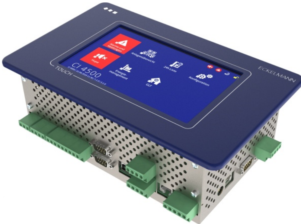
Systemzentrale der CI 4000-Reihe mit Touch-Display.
